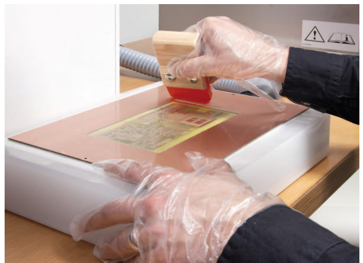
Bild 4: Bei der pastösen Durchkontaktierung zieht ein Vakuumschis die Kontaktpaste durch die gebohrten Löcher in der Leiterplatte
