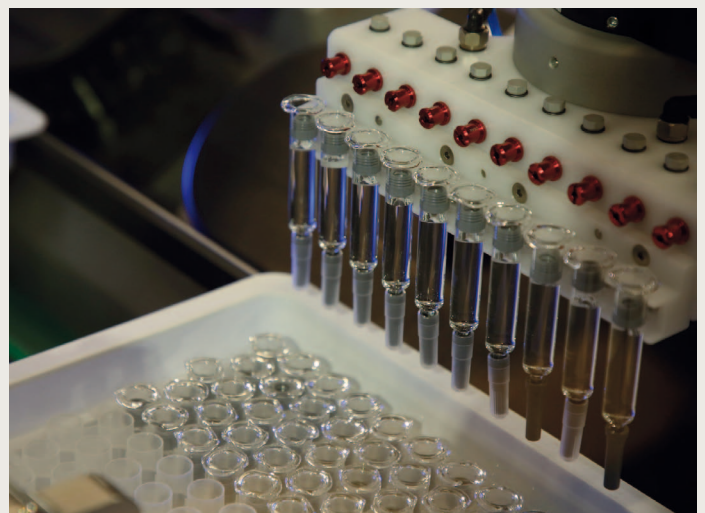
Bild 4: Hier werden die gefüllten Spritzen wieder in die Trays aufgegeben
