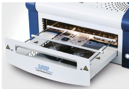
Bild 8: Ein moderner, kompakter Reflow-Ofen sorgt für eine gleichmäßige schonende Lötung bei PCB Prototypen
