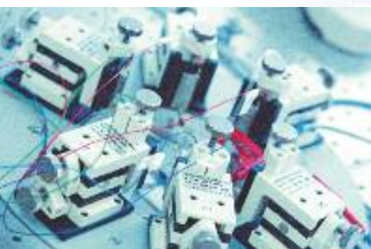
Vermessung von optischen MEMS-Strukturen, basierend auf flexibel positionierbaren Prüfspitzen
