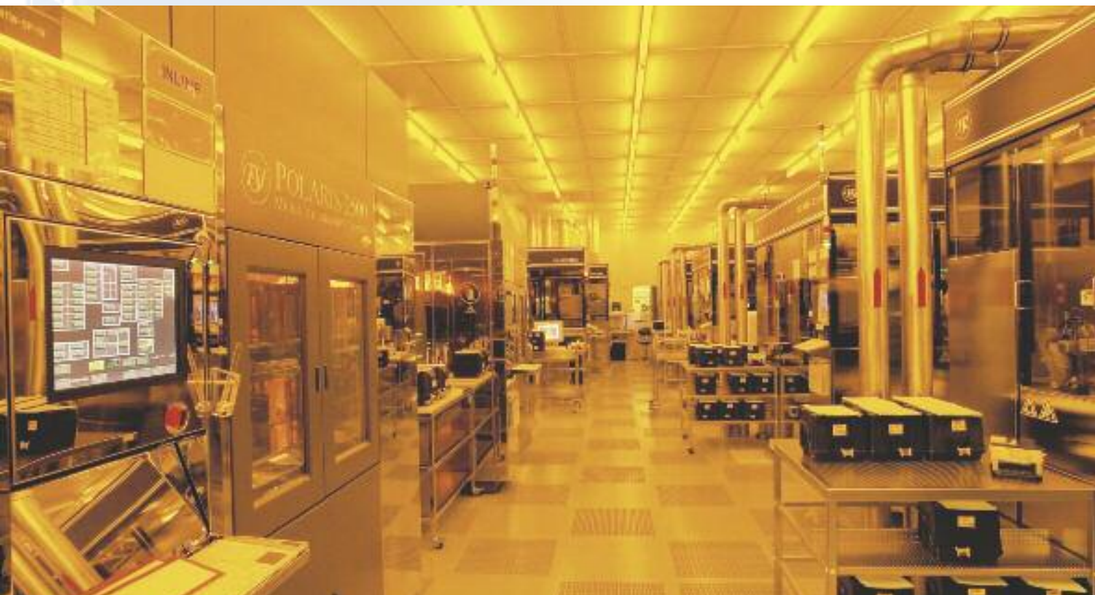
Reinraum zur Beschichtung von Wafern mit Fotomaster der Micronas GmbH
