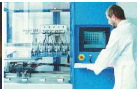
In Kooperation von IMTEK und HSG-IMIT gefertigte TopSpot®-Anlage für die Produktion von Biochips
