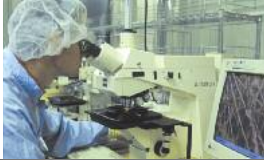
Charakterisierung von mikrosystemtechnisch gefertigten Bauteilen im Reinraum
